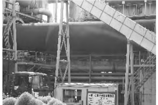
セメントキルンに似た焙焼炉。焼却灰や汚染土壌を高温焼成して無害化する。
