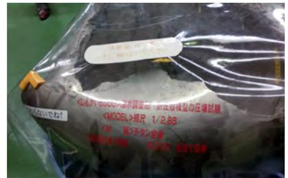
の対水圧試験を行う所で大中の二つの高圧水槽を有し「しんかい6500」の人が入るチタン製耐圧殻の繰り返し耐圧テストを1500回以上行い安全性を確認したそうです。さらに高圧を駆け深度13000m相当以上の圧力で破壊テストも行ったそうです。その破断面を見ると圧力の脅威が感じられます。又カップラーメンの容器による100気圧水深1000m相当の水圧力による変形度合いもお勉強しました。(写真)
