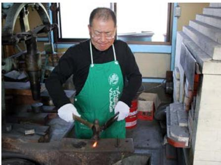
歪(反り)を適度に修正していただきます。⑥サンドペーパーにてバリ取りをします。⑦焼き入れが
